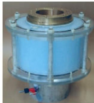
Prüfgefäß für elektrische Untersuchungen des neuen Füllmaterials
