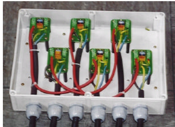
Abb. 3: Auskreuzung von Wassersensoren
